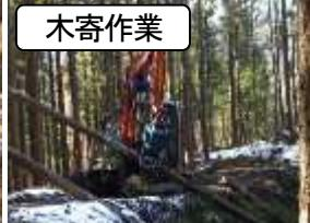
林地内に散在している伐倒木を作業しやすい場所まで集める作業です。機械やウィンチによって木を集めます。
