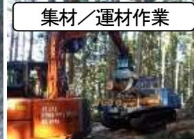
造材された丸太を集め、大型トラックに積込みが可能な場所（土場）まで運ぶ作業です。丸太を掴む専用のアームが付いた運材車をフォワーダーと言います。
