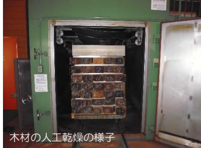
試験体運搬木材の人工乾燥の様子
