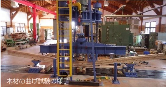
木材のクリーブ試験の様子
