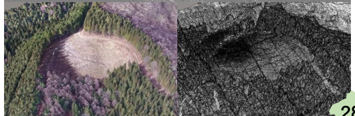
ドローンの撮影画像から3次元点群データを作成
