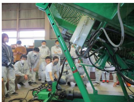
斜面（傾斜）を再現。同じ伐倒 環境を再現可能。 0度～25度までの6段階設定。
