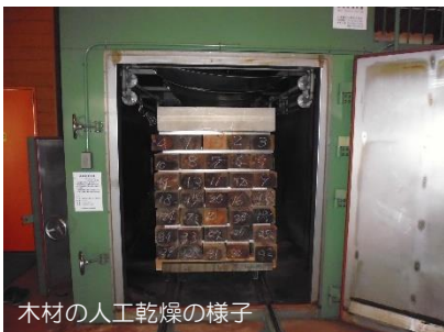
試験体運搬木材の人工乾燥の様子
